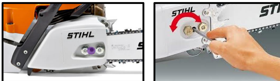
Figuras 26 y 27. Tensor de cadena. Fuente: Stihl
